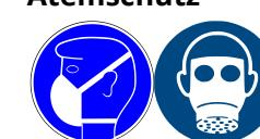
Atemschutz ist erforderlich bei: Staubentwicklung. Partikelfiltergerät (EN 143). P2 (filtert mindestens 94 % der Luftpartikel, Kennfarbe: Weiß).
